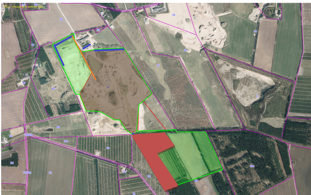
Figur 3 Principiel placering af muld-/støjvolde under indvinding, er vist med blå streg. Med orange streg er vist principiel placering af støjvold når området vest for er færdigindvundet og skal efterbehandles. Med rød flade vises arealer som er udtaget af denne delafgørelse, men fortsat sagsbehandles
