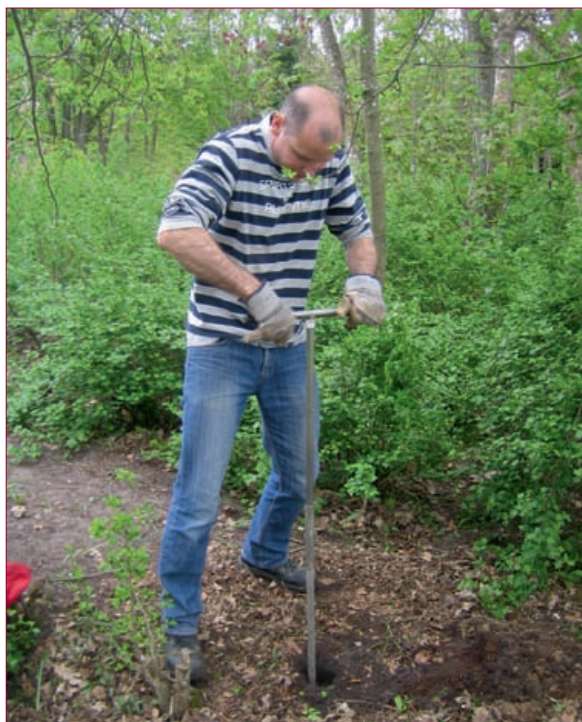
Regionsmedarbejder udfører håndboring i forbindelse med en boligundersøgelse, forår 2010.
