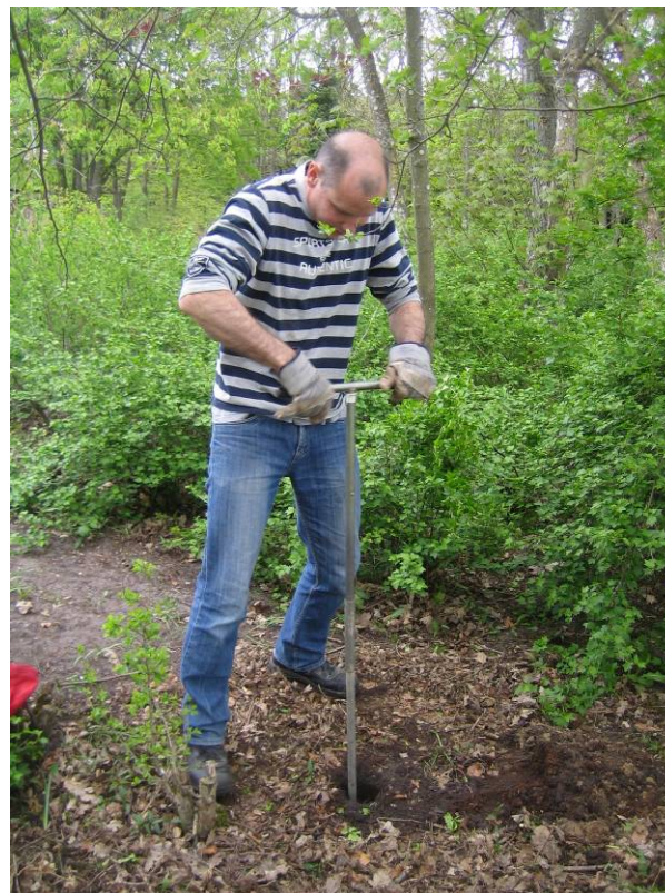
Håndboring i forbindelse med boligundersøgelse
