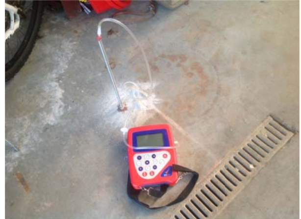
Gasmåling under gulv via et 12 mm spyd
