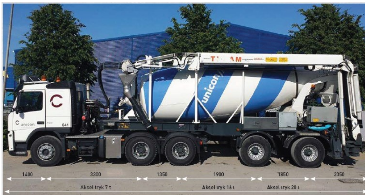
Figur A6.2 Denne betonkanon fra Unicon kan laste 12 m 3 fabriksbeton.
