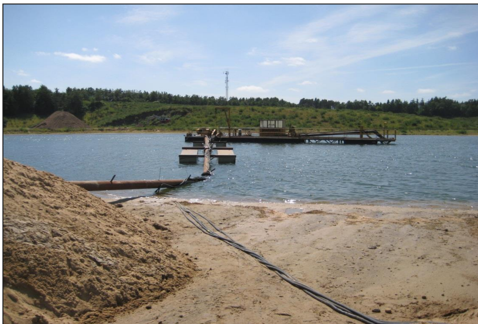
Figur 2-9: Sandsuger. Bunken til venstre på fotoet er materiale, som er indpumpet fra sandsugerens.
