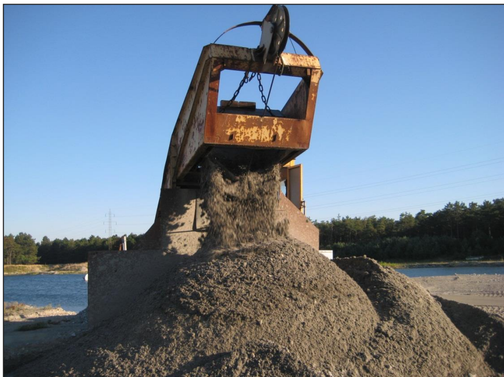
Figur 2-16: Tømning af skovl fra slæbeskovlsspil.
