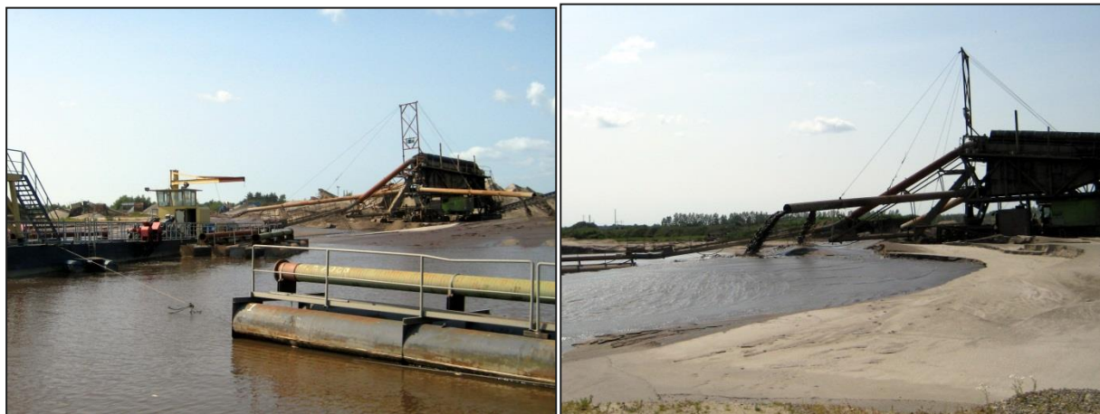
Figur 2-23: Foto til venstre: Indvindingsfartøj til venstre i billedet. Til højre ses sorteringsanlægget. Foto til højre: Sorteringsanlæg med udløb af vand og finkornet sediment (mørkfarvet vandet).
