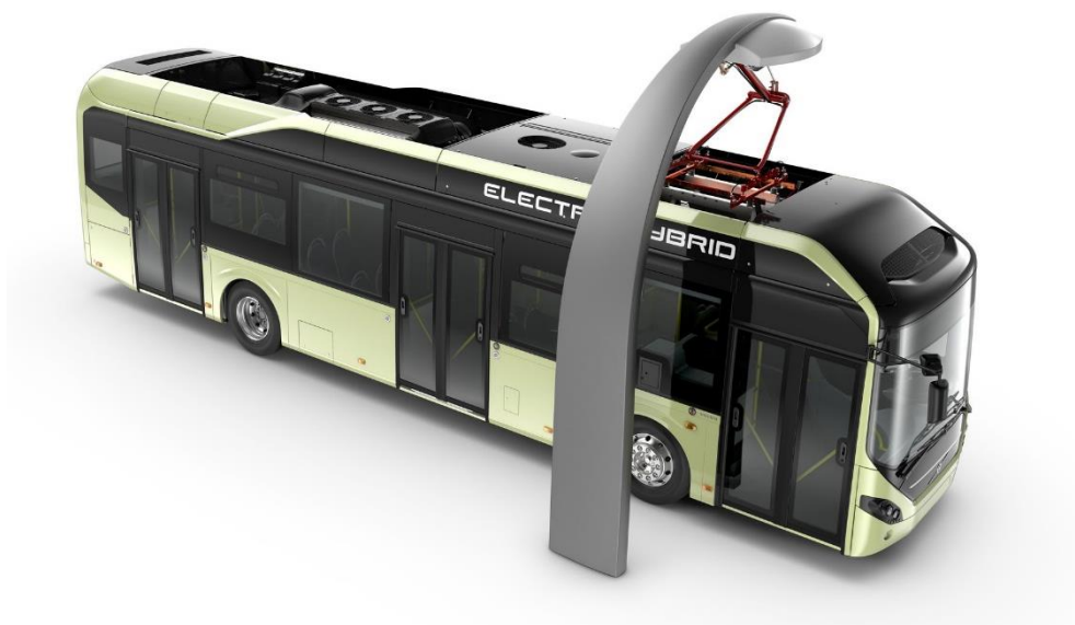
Figur 9 Skitse af en Volvo plugin hybrid bus, der oplades ved hjælp af en pantograf-løsning. Kilde: Insideevs.com
