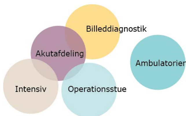
Figur 1: Konceptdiagram over hensigtsmæssige nærhedsforhold mellem billeddiagnostisk afdeling, OP, intensiv og akutafdeling.
