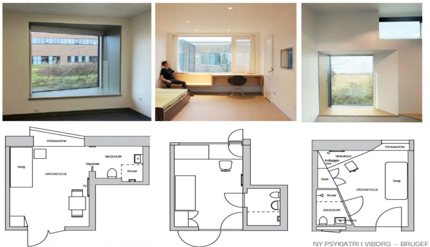
Figur 4. Eksempler på forskellige typer vinduespartier i sengestuer fra Brugergruppeoplæg, Ny Psykiatri i Viborg
