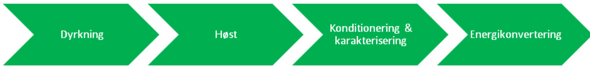
Figur 1. Flow i produktionskæden fra dyrkningen af alger over høst, forbehandling, karakterisering og endelig energiproduktion.
