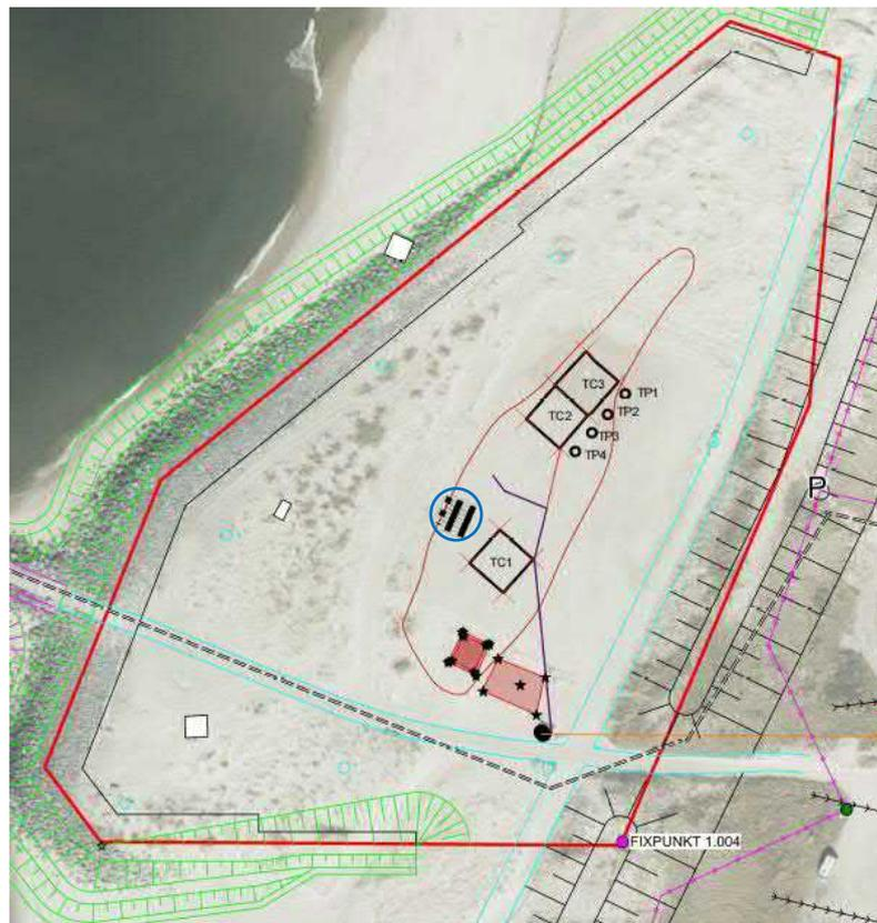
Figur 3.3. Markering af områder med genindbygning. Den røde skravering mod øst angiver indbygning af jord fra 2012. Den røde skravering mod vest er en tidligere genindbygning. Den røde streg angiver spunsen og de sorte markeringer er testceller og testrør i forbindelse med NPC-projektet. Blå cirkel angiver placering af nedsivningsdræn.
