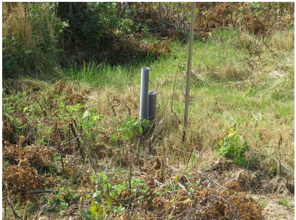
Figur 3.5. Eksempel på monitoringsboring.
