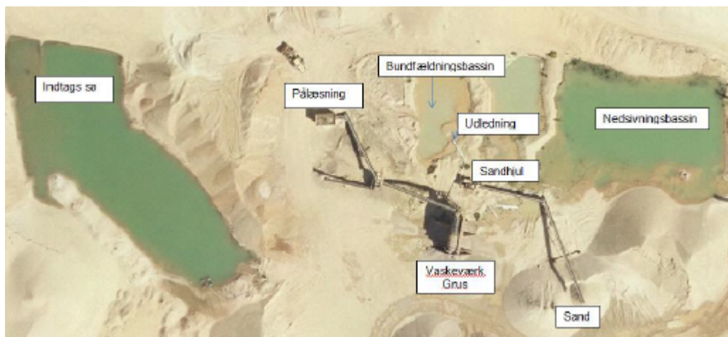
Figur 3. Vaskeværk, som det er sat op i Ølstруп.
