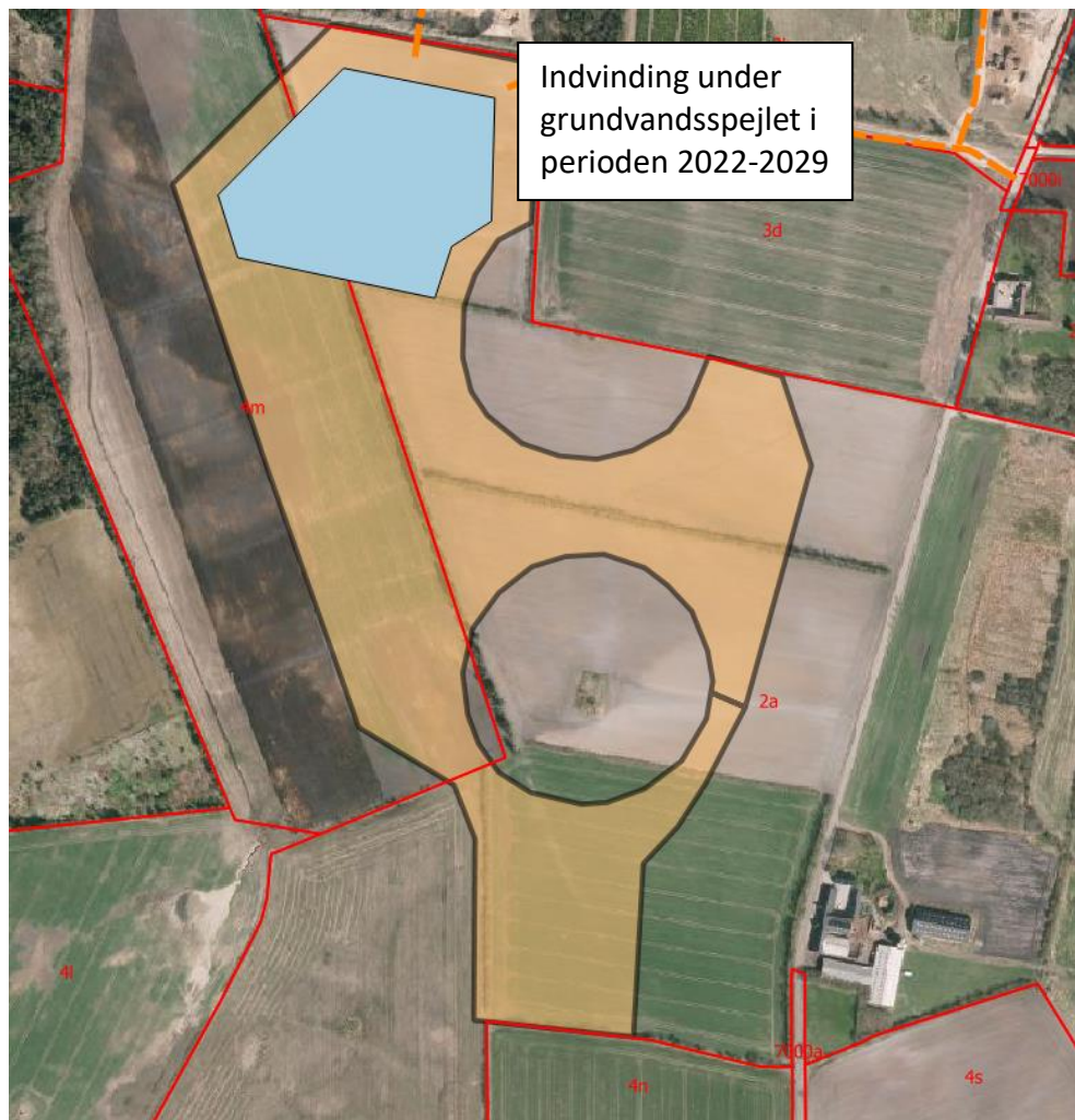
Figur 2- Vådgravning – der indvindes fra syd mod nord for at sikre frakørselsmuligheder. Det blå felt viser den maksimale udgravning under grundvandsspejlet.
