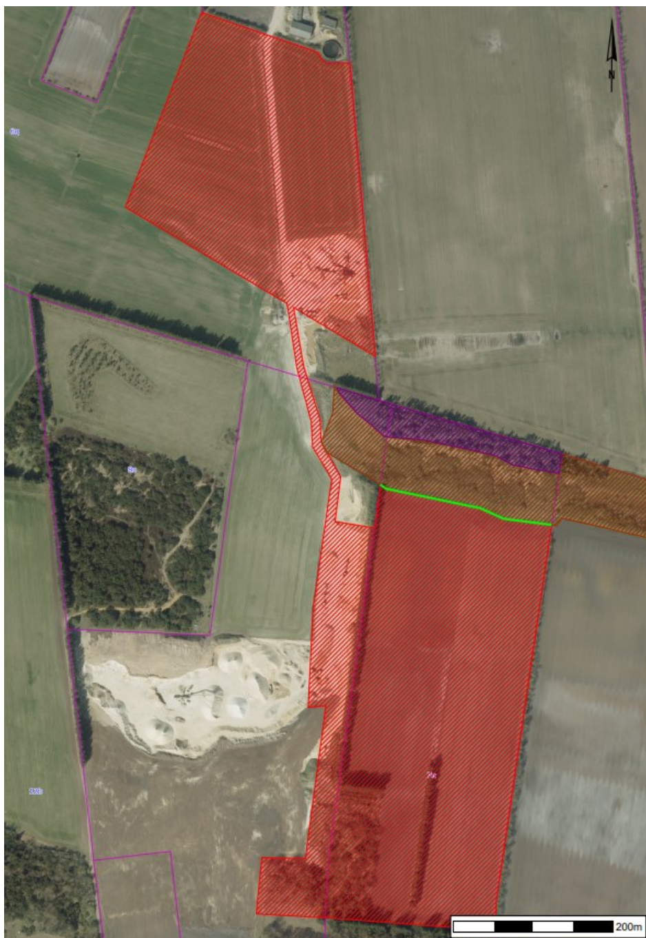
Kort 1: Invindingsområdet er vist med rød skravering, mens at den beskyttede mose er vist med brun skravering. Der skal anlægges en jordvold langs den grønne linje.
