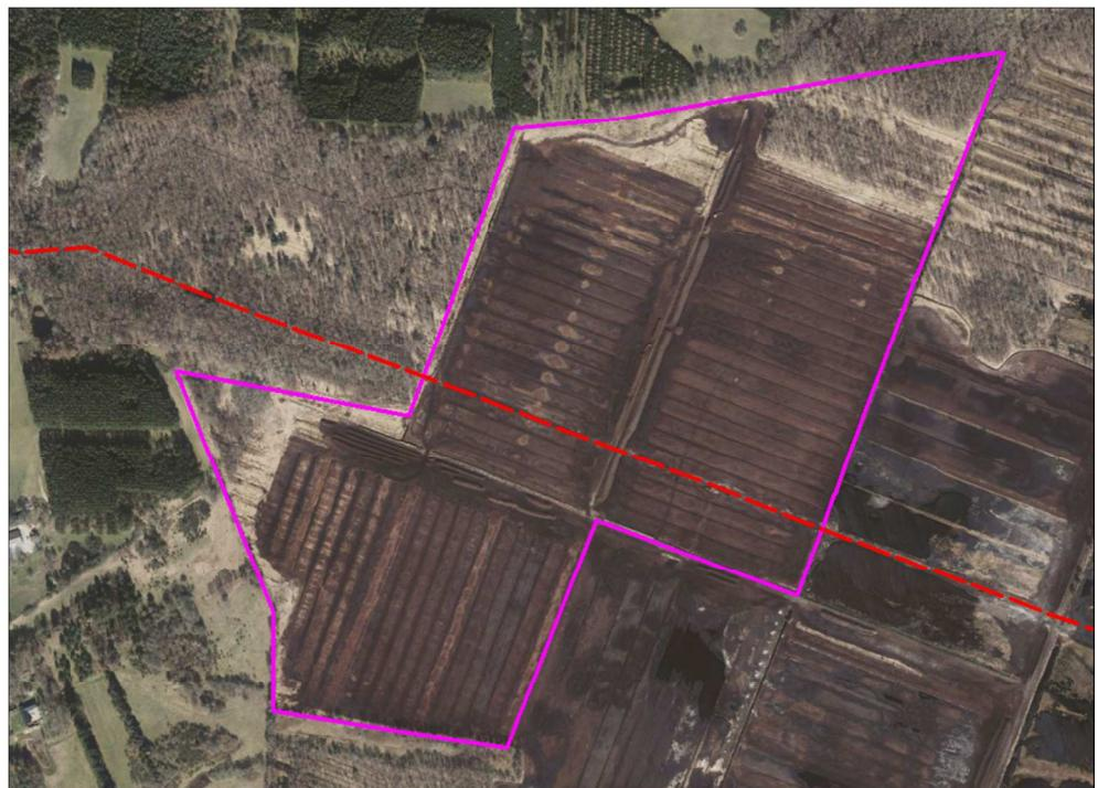
**Figur 6.** Forløbet af den dybe rørledning igennem Fuglsø Mose vist med rør striplet streg sammen med det ansøgte indvindingsområde i optrukket lyslilla streg vist i samme udsnit som på Figur 3 og Figur 4 på baggrund af GeoDanmarks ortofoto fra foråret 2019 i skala 1:10.000, © SDFE og Danske Kommuner.
