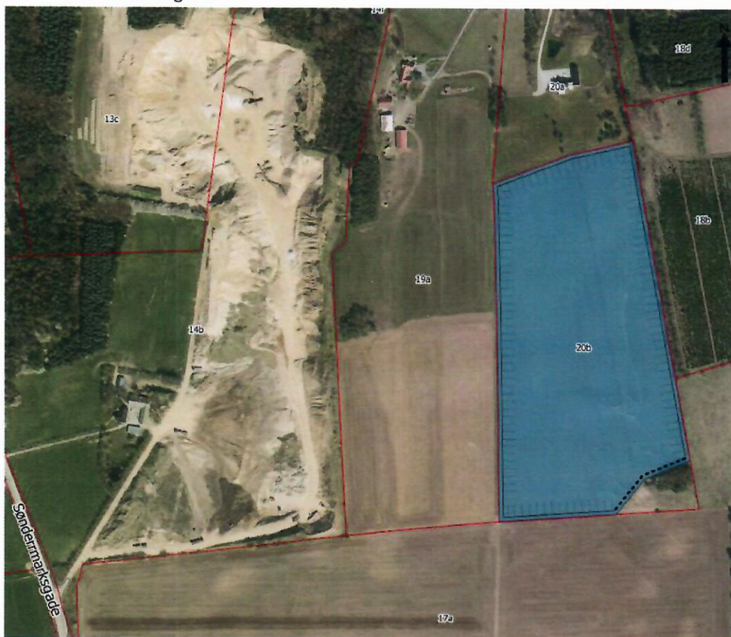
Figur 2: Graveområdet er vist med blå, efterhandlede skrånninger er vist med sort streg og 'tværstreger' og område med efterbehandling i hht. landskabelige hensyn er vist med sorte prikker. Målfast kort er vedlagt i bilag 3
