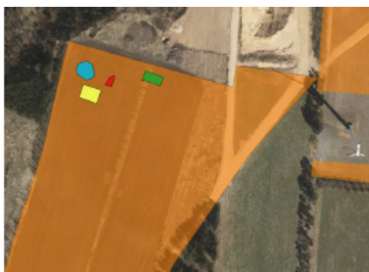
Figur 2. Placering af vaskeværk (gul), indtagssø (blå), bundfældnings-/nedsivningsbassin (rød) og skurvogn (grøn).
