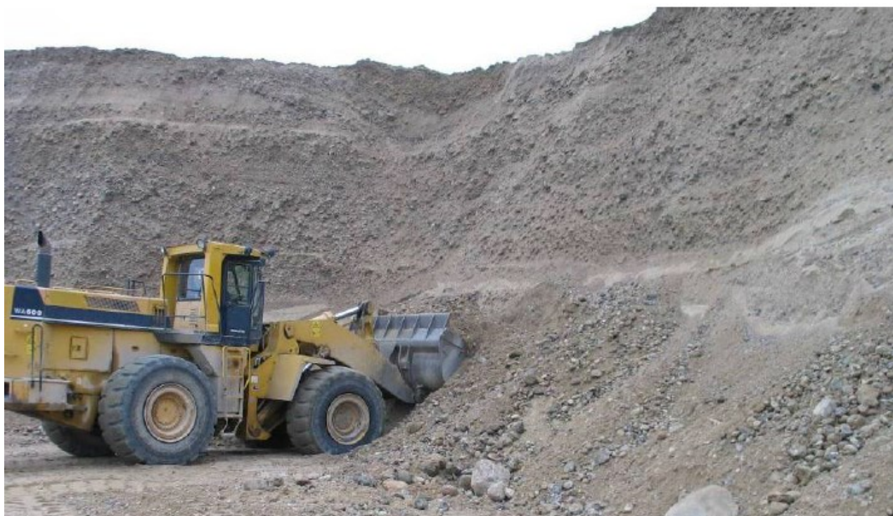
Figur 4: Gummiged graver grus ved gravefronten.
