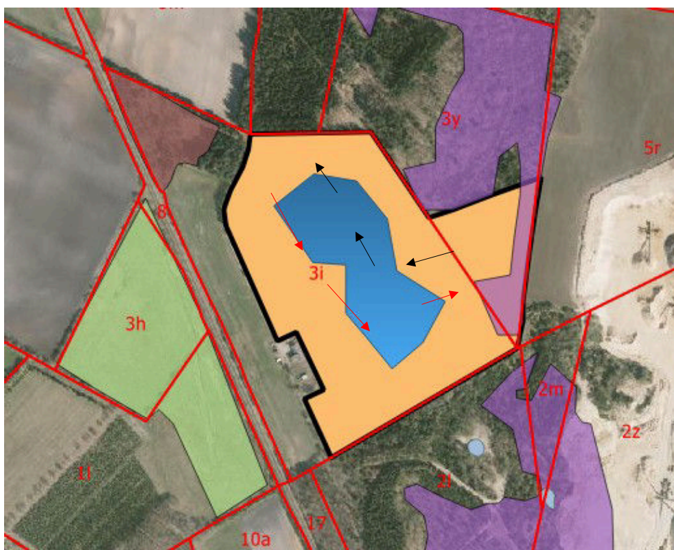
Indvinding i det ansøgte område. Sort er tørgravning, rød er vådgravning.
