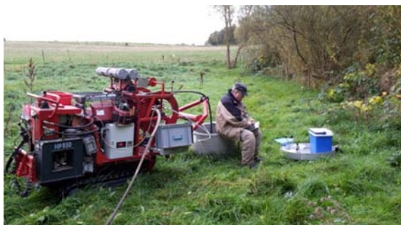
Region Midtjyllands selvkørende pumpe- vogn til udtagning af grundvandsprøver fra borer
