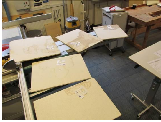
#2 Nedtagne loftplader. Plader har været opbevaret i samme pose som skim-melangrebet plade (tidligere testet til MV=776 jf. RM-notat 1-30-77-178-14 ).
